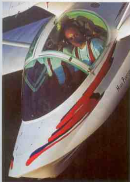
Três momentos do Super Petrel: a cabine (à esquerda) oferece excelente visibilidade e o novo formato da fuselagem-casco, baseado em desenhos de barcos de corrida, melhorou o desempenho na água e reduziu o arrasto em voo; no centro, janela de inspeção para fins de manutenção também ajuda a identificar se há acúmulo de água no casco; o cone de cauda (à direita) agora é uma peça única, fixa, por onde passa o sistema de cabos que atuam nos profundos
