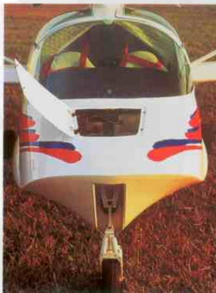
Três momentos do Super Petrel: a cabine (à esquerda) oferece excelente visibilidade e o novo formato da fuselagem-casco, baseado em desenhos de barcos de corrida, melhorou o desempenho na água e reduziu o arrasto em voo; no centro, janela de inspeção para fins de manutenção também ajuda a identificar se há acúmulo de água no casco; o cone de cauda (à direita) agora é uma peça única, fixa, por onde passa o sistema de cabos que atuam nos profundos
